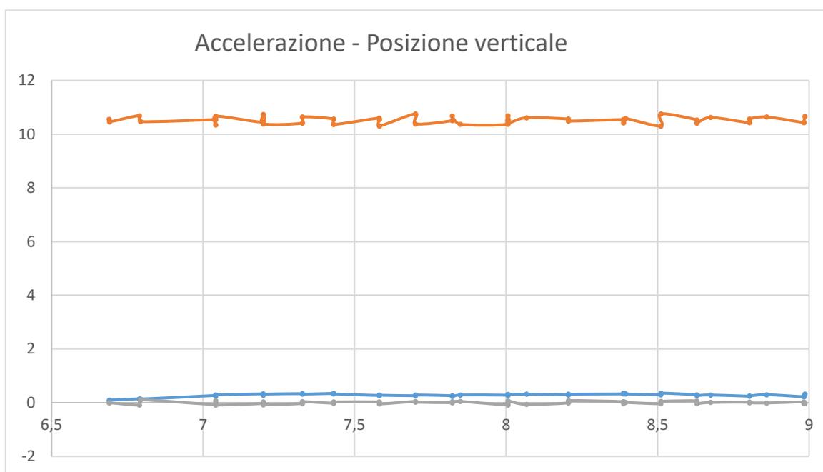
L'asse z, al quale corrisponde il grafico arancione, è quello in direzione verticale, corrispondente all'altezza dello smartphone. In una situazione di quiete registra l'accelerazione di gravità. Come si può notare, il dispositivo utilizzato misura un dato leggermente maggiore a quello previsto, ma comunque compatibile con il valore di  $9,8 \text{ m/s}^2$ .
