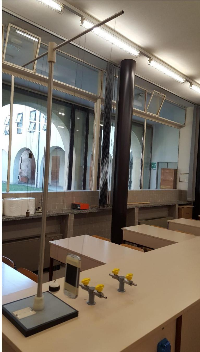
Si misura la distanza verticale fra il centro dello smartphone e la barretta trasversale a cui è appeso il filo, eventualmente utilizzando un catetometro.
