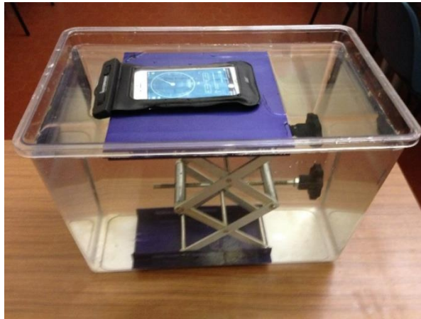
Figura 2. Lo smartphone, inserito nel sacchetto waterproof, viene adagiato sopra il pantografo elevatore.
