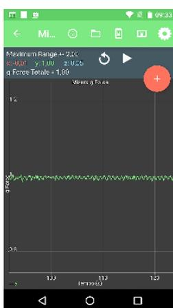
Perché l'accelerometro segna il valore di 1,00 g e non 0,00 g? Per rispondere si consideri che il dispositivo elettronico che misura l'accelerazione si comporta in realtà come un dinamometro che, se disposto in verticale, si flette verso il basso sotto l'azione del proprio peso; è proprio questo che l'applicativo mostra.
