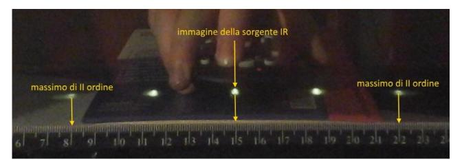
Nella prova svolta, come si può vedere dalla foto sopra riportata, la distanza fra il massimo centrale e i massimi di II ordine è di
